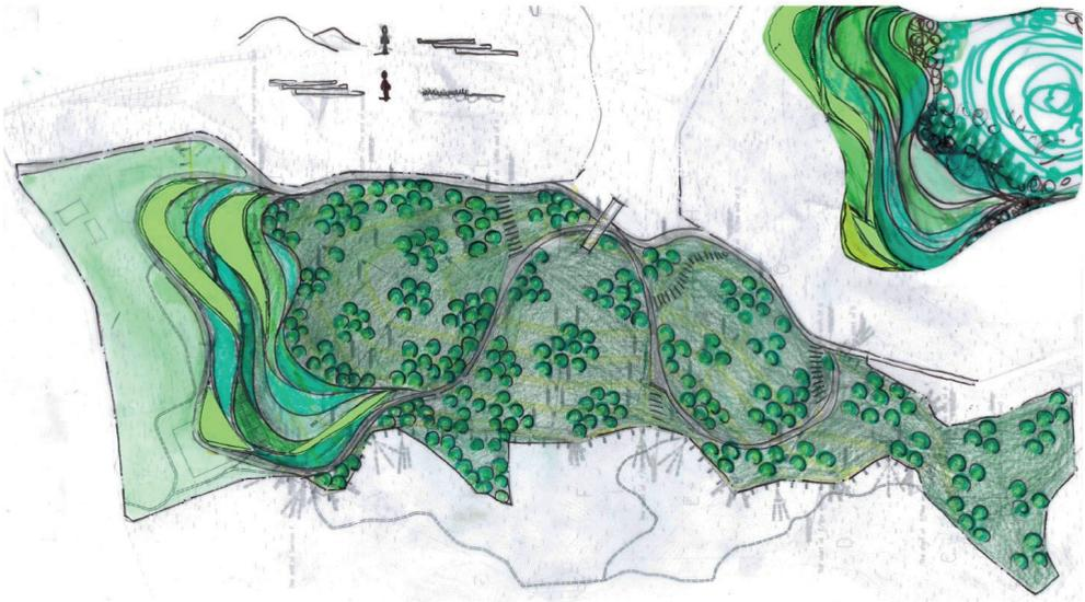
**Figura 7.5b.** Schizzo preliminare al progetto. Studio dell'inserimento del landmark tipico della zona di intervento (la risaia cinese) nella linea paesaggistica della discarica.
